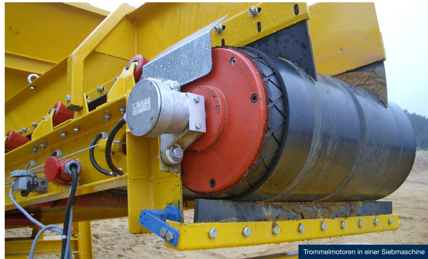
Trommelmotoren in einer Siebmaschine
